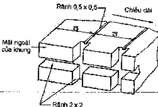
**Hình A.5: Tiết diện của khung chữ U phía dưới được thiết kế có dây đờ**
