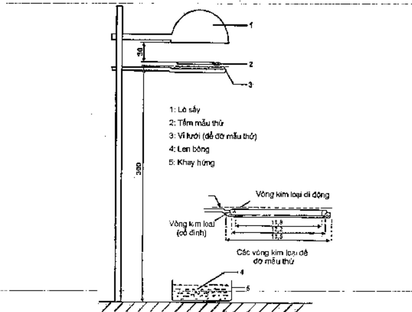
Hình B.1: Thiết bị thử nghiệm xác định đặc tính nóng chảy của vật liệu
