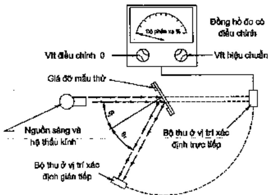
**Hình B.1- Sơ đồ khái quát hệ thống đo hệ số phân xạ**
